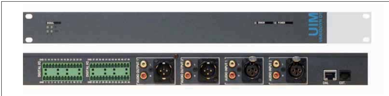
Fig.: Universal-interface-module (UIM)
